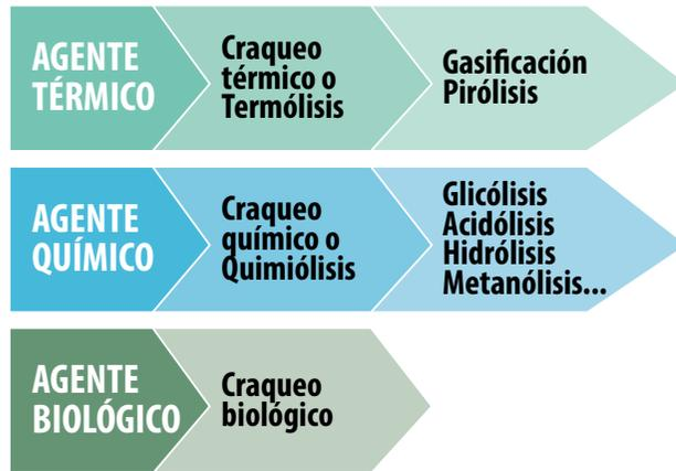
**Craqueo térmico (Termólisis).** La rotura de la cadena polimérica se produce gracias a la acción de la temperatura y en algunos casos mediante el uso de catalizadores. Los principales procesos o técnicas son la **pirólisis** (en ausencia de oxígeno) y la **gasificación** (con oxígeno). Generalmente, la termólisis tiene lugar en condiciones más estrictas que en una combustión total. Es aplicable a residuos compuestos tanto por polímeros de adición como de condensación.
