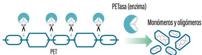
**Craqueo biológico:** La rotura de la cadena se produce mediante el uso de enzimas como biocatalizadores, degradando los polímeros tanto de adición como de condensación en monómeros u oligómeros. Las enzimas son muy selectivas, por lo que se debe seleccionar de forma apropiada.
